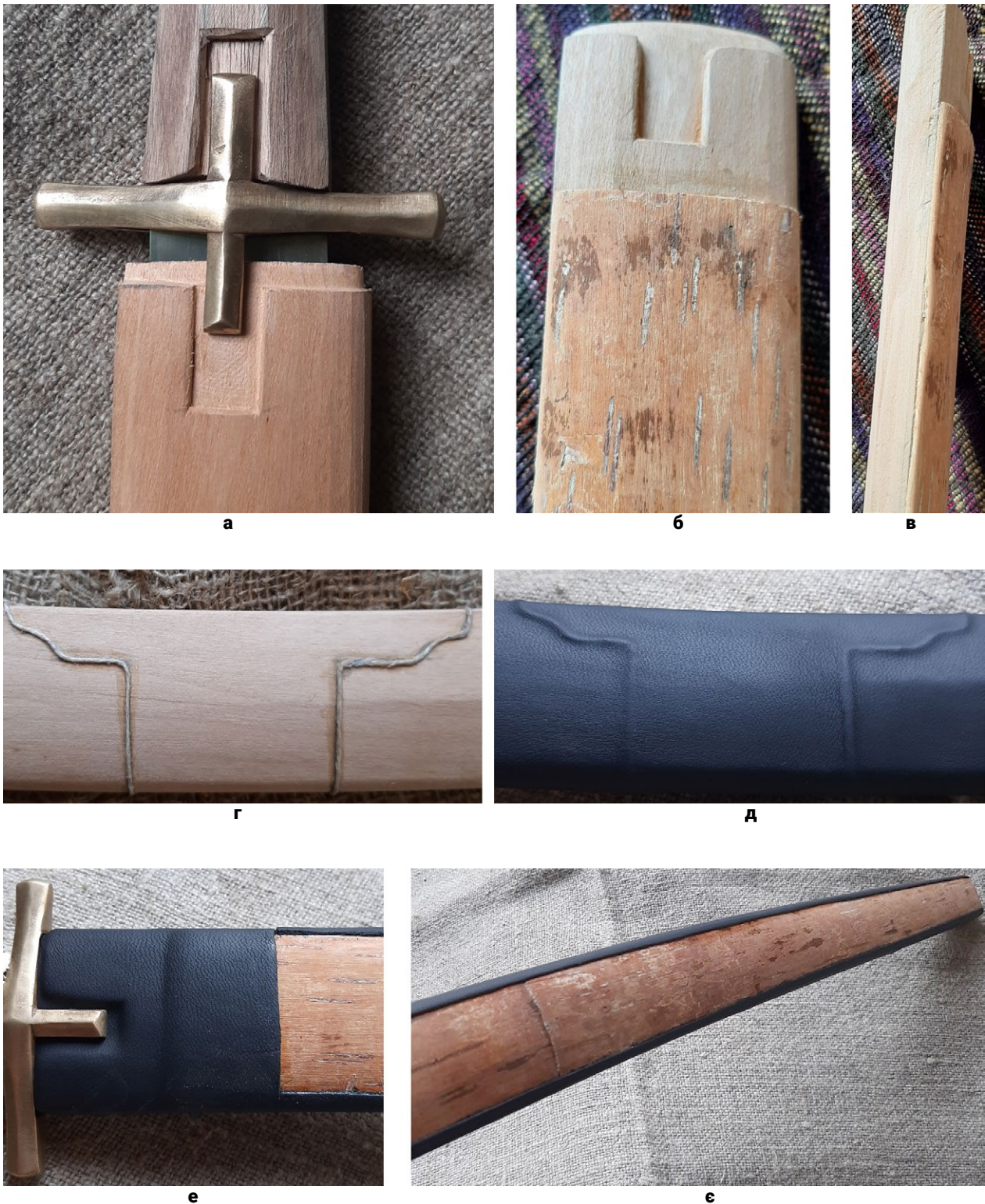
Мал. 7. Деталі виготовлення піхов: (а) – підрізка устя під форму перехрестя; (б, в) – покриття тильного боку шаром бересту; (г, д) – виготовлення валиків для фіксації елементів оправи; (е, є) – вигляд тильного боку піхов після наклейки шкіри.
