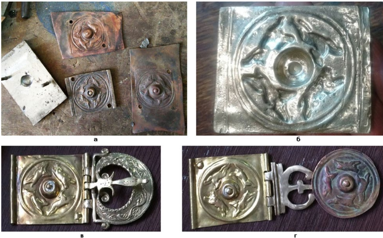
Рис. 5. Процес виготовлення поясних накладок:
