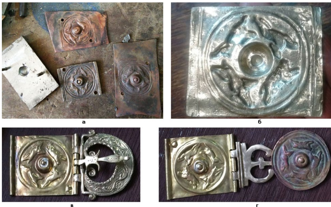
Рис. 5. Процес виготовлення поясних накладок:
